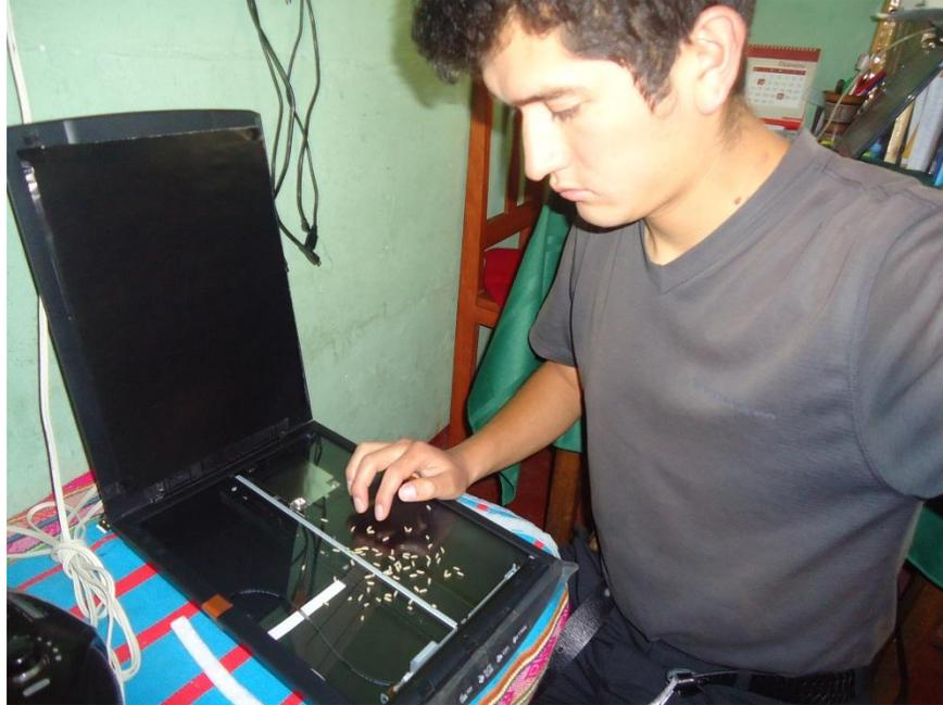
**Paso 2:** Haciendo uso del software del escáner, iniciar la digitalización de la imagen (300ppp).
