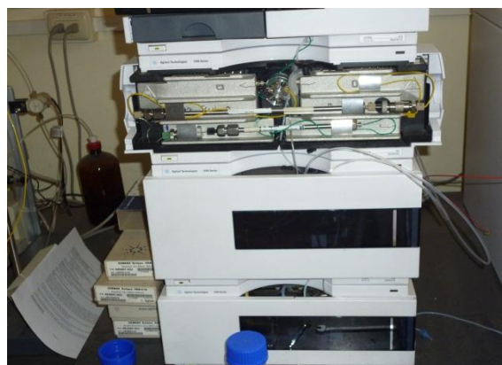
FOTO 12: COLUMNA INSTALADO EN EL HPLC
