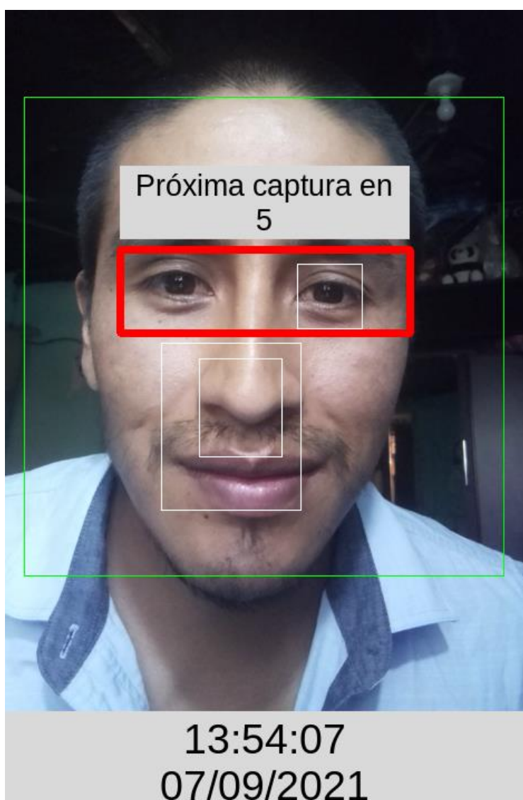
Figura 67. Detección nariz y boca para identificar el uso de mascarilla.
