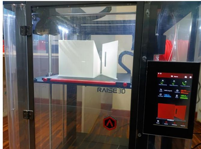
Una vez concluida la impresión, se dejó en reposo para que podamos desmoldar de soporte de la impresora. En este punto ya se encuentra listo para su armado y equipamiento de los componentes electrónicos a utilizar.
