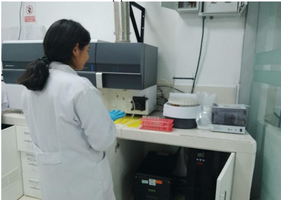
Fotografía 08 Determinación de Metales con el equipo ICPE
