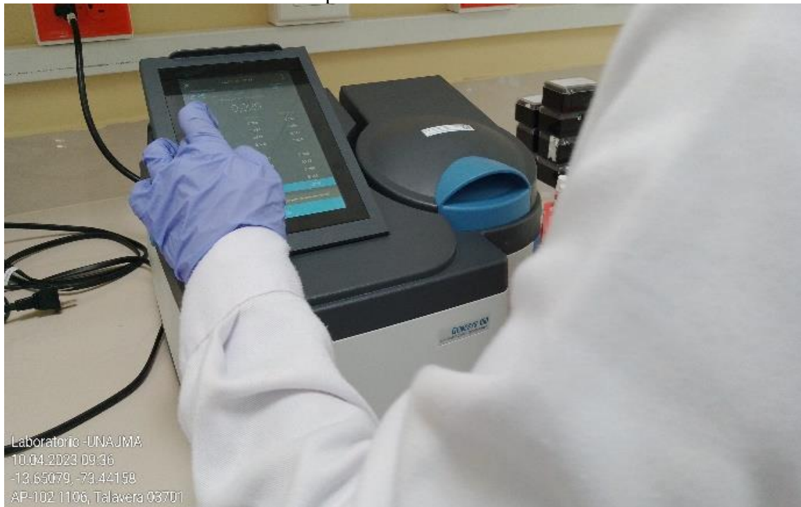
Fotografía 15 Medición de la absorbancia en el Espectrofotómetro
