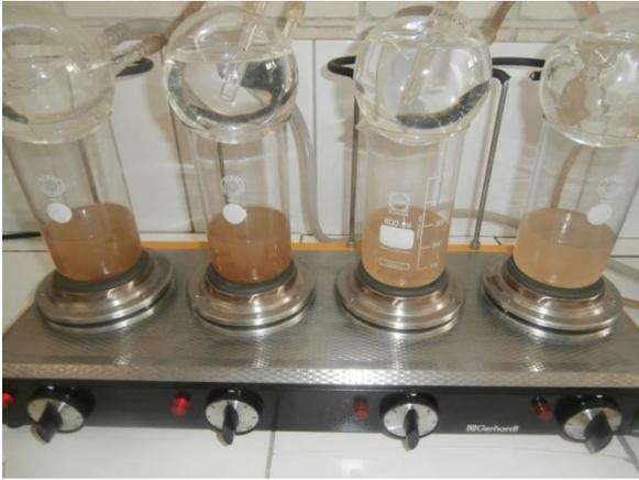
FOTO 48: Digestando la muestra de panes en ácido sulfúrico al 1.25% para la determinación de fibra
