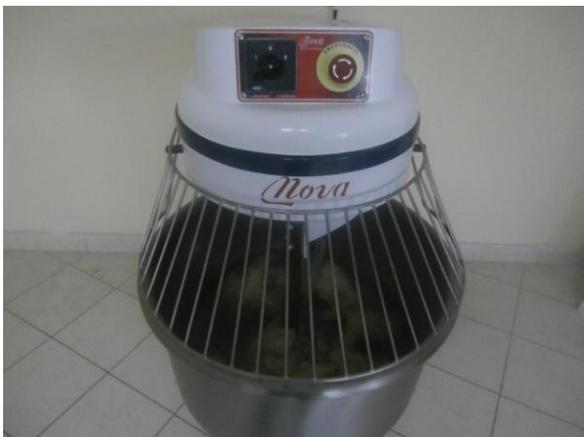
FOTO 16: Amasando la masa de los panes en la amadora espiral NOVA-25
