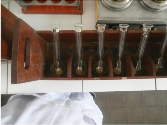
FOTO 38: Acondicionando las muestras de panes en los balones kjeldahl
