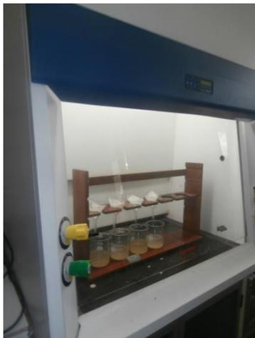
FOTO 50: Filtrado de las muestras en la campana de gases
