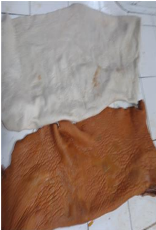
Foto 10: Piel curtido con tara y queñua por separados
