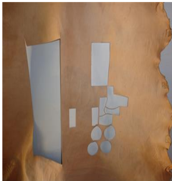
Foto 15: Localización de zona de muestreo para el análisis de propiedades físicas del cuero curtido de ovino
