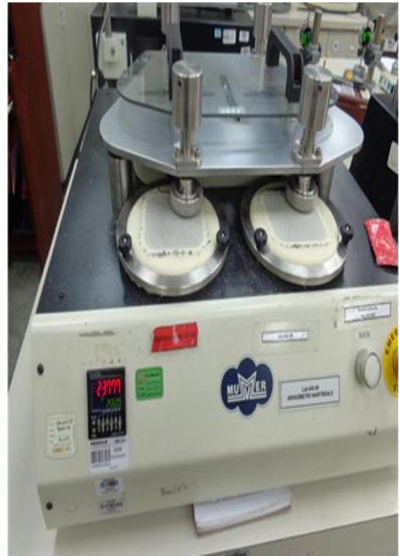
Foto 12: Abrasimetro rotacional Martindale
