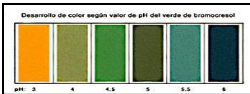
Figura 11 Escala fotométrica verde bromocresol. (Galego, 2013)
