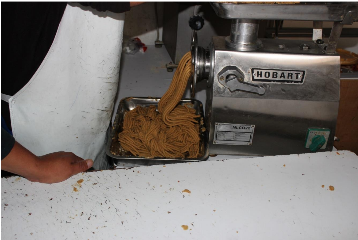
Fotografía 4. Pelletizado de alimento formulado para la alimentación de cuyes gazapos en crecimiento.
