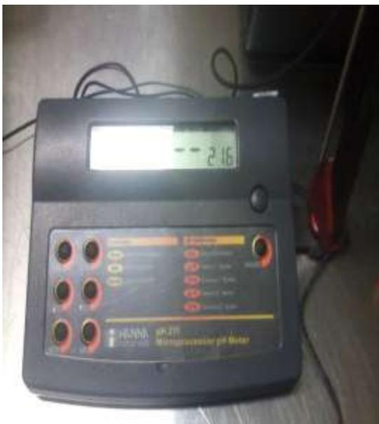
**Foto 03. Potenciómetro pH211 HANNA instruments**
