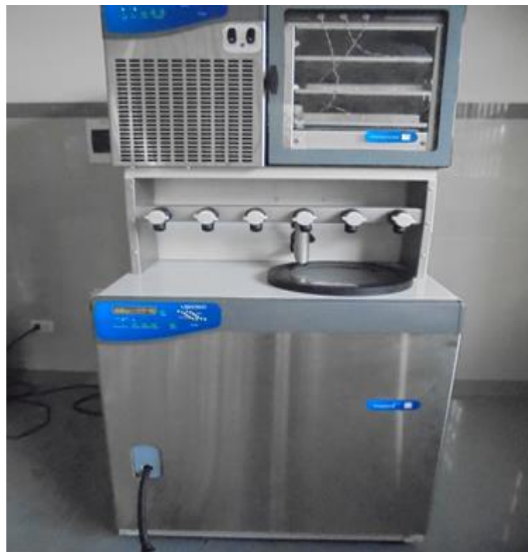
Liofilizador marca LABCONCO MODELO 7754040
