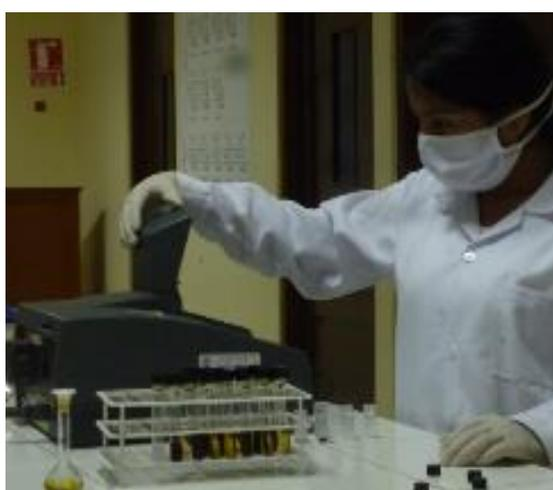
IMAGEN 11: LECTURA DE ABSORBANCIA ESPECTROFOTOMÉTRICO
