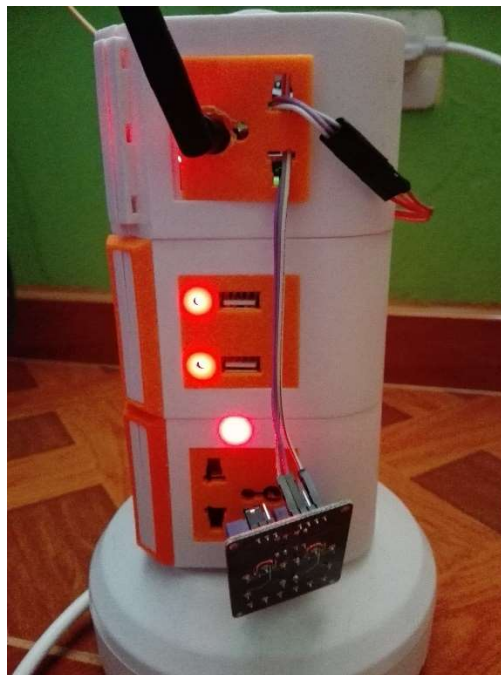
Figura 47: encender rele3 y led3
