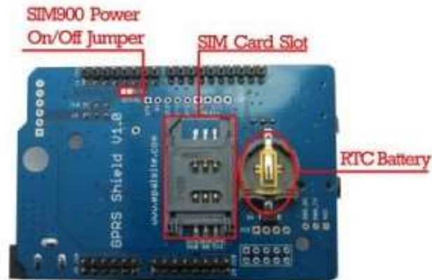
Figura 14: Ranura para la tarjeta SIM
