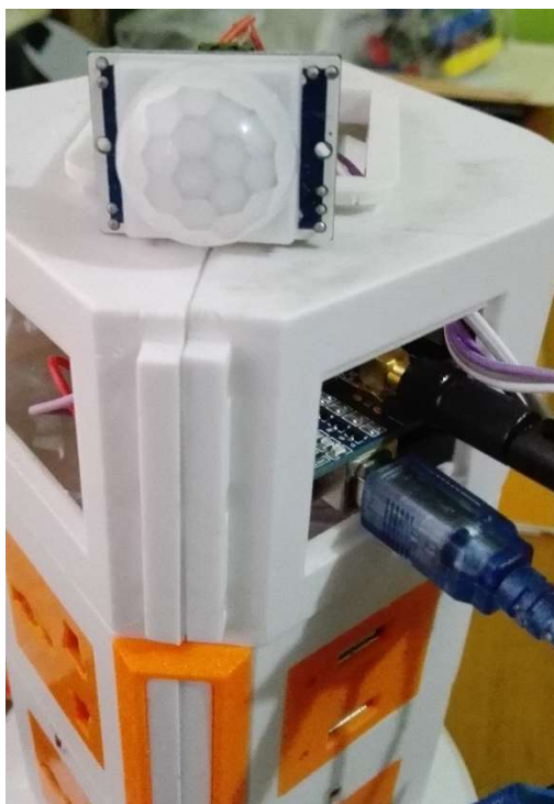
Figura 49: sensor PIR conectado al módulo
