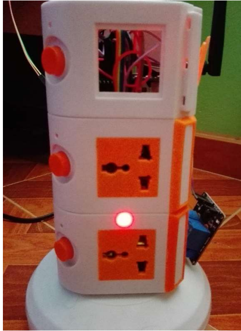
Figura 46: encender rele2 y led2
