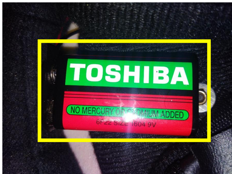
Figura 45: Batería en el interior del casco
