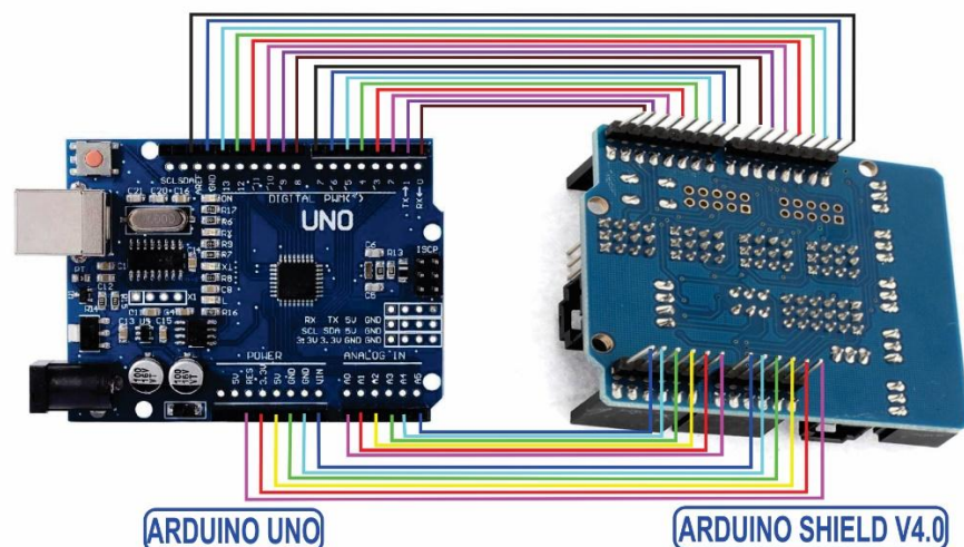
Figura 21: Conexión Arduino Uno con Arduino Shield
