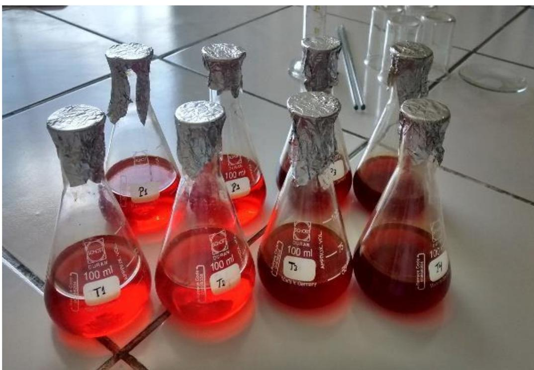
**NEXO 3: IMÁGENES DE PROCESO DE DETERMINACIÓN DE pH DEL COLORANTE DE LOS TALLOS DE YANALI (*Bocconia frutescens*) A LOS PORCENTAJES DE ÁCIDO CÍTRICO Y ETANOL (0.03 Y 0.05) % CON (35 Y 90) % RESPECTIVAMENTE DE A UNA TEMPERATURA DE 60°C POR 24 HORAS.**
