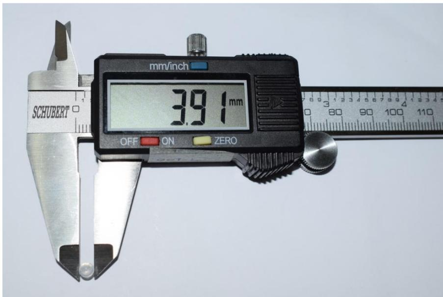
Imagen 14: Medición del diámetro de la Inmovilización de *Kluyveromyces fragilis* NRRL Y-2415 en agar.
