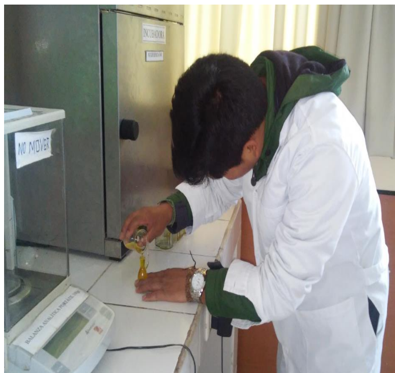
Fotografía 18. Obtención de datos para obtener la densidad del aceite.
