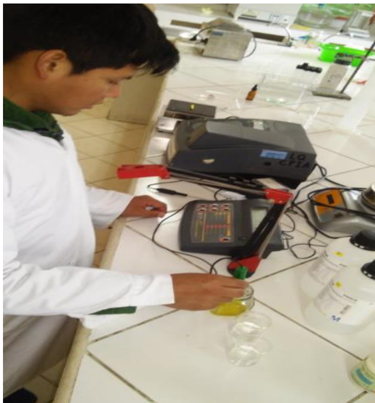
Fotografía 16. Medida del pH vía potenciómetro.
