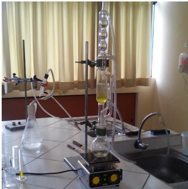
Fotografía 13. Extracción del aceite de tarwi.
