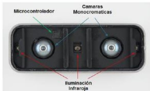
Figura 9 Partes del sensor Leap Motion
