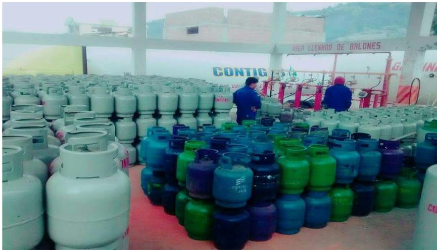
Envasado y pesaje de los cilindros de gas
