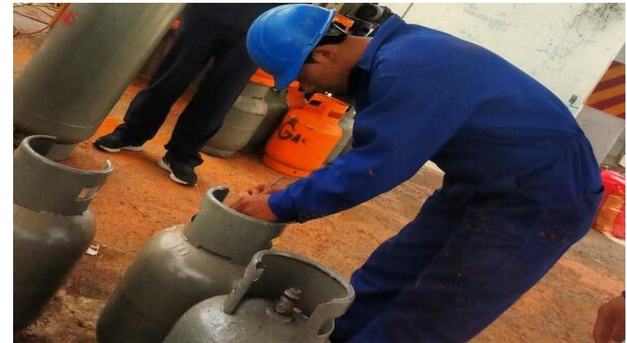
Sellado de los cilindros de gas después del envasado
