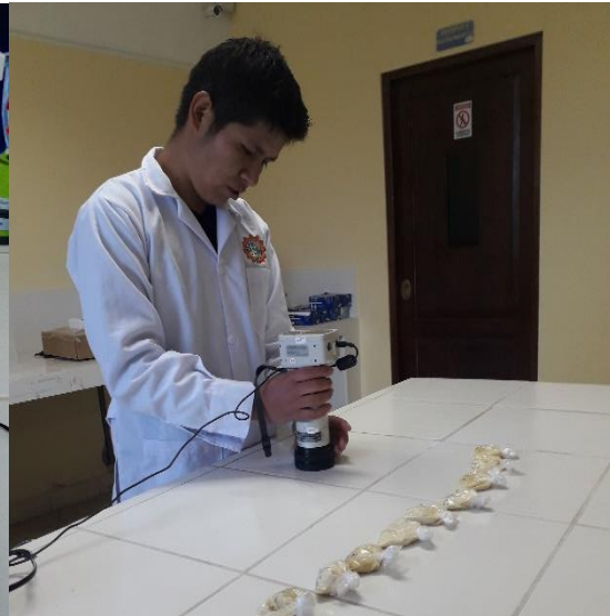
Fotografía 6. Determinación del color en espacios L^* , a^* y b^* .
