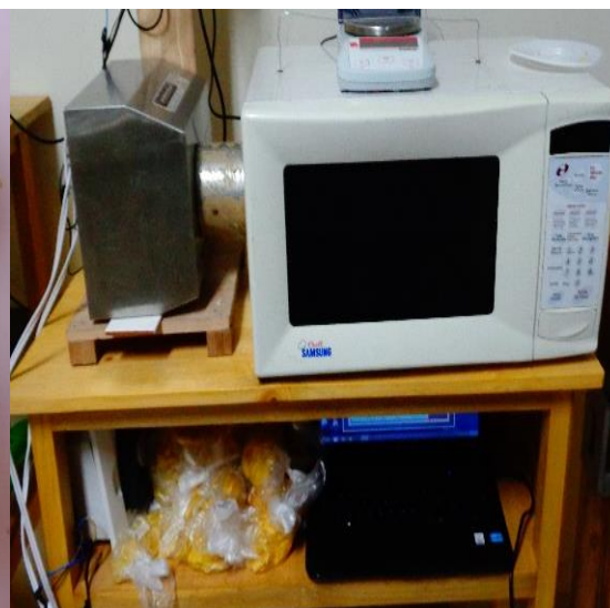
Fotografía 2. Equipo de secado con corriente de aire caliente (convección)
