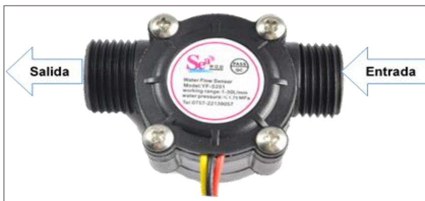
Figura 19: Sensor de flujo YF-S201. Fuente: Elaboración propia.
