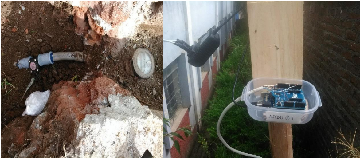
Foto3: Conexión del sensor con el microcontrolador arduino y el radio Xbee
