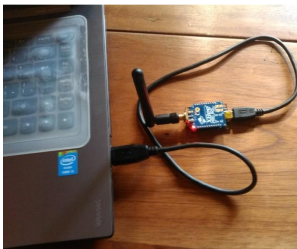
Figura 39. Conexión del Xbee al ordenador. Fuente: Elaboración propia.
