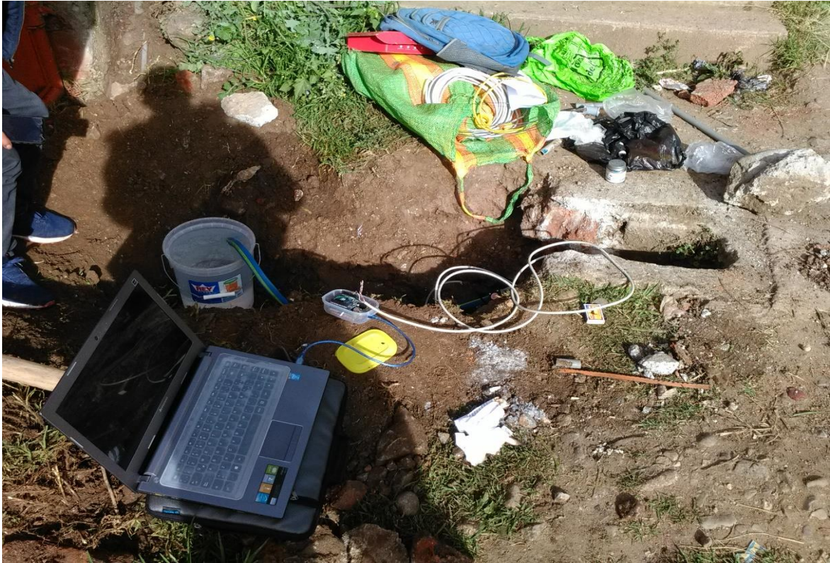
Foto2: Calibración del sensor de flujo con la ayuda de un recipiente graduado.
