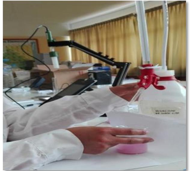
**Imagen 6:** Cambio de color por unos segundos indicado la presencia de ácido
