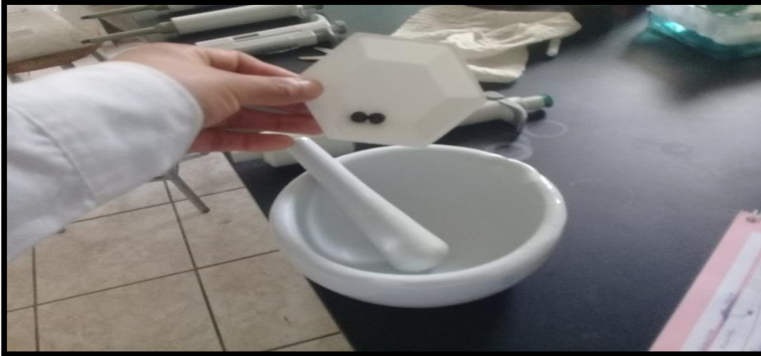
Imagen 5: Una vez realizado el pesado de 1g de las muestras de frutos de sauco se tritura con un mortero para luego añadirle 10 ml de metanol al 70%.
