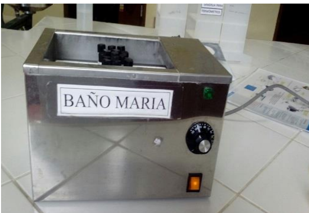
FOTO 18: PREPARACIÓN DE MUESTRA DE TUBO "A" A 90 °C DURANTE 30 MINUTOS TAPADO EN BAÑO MARIA
