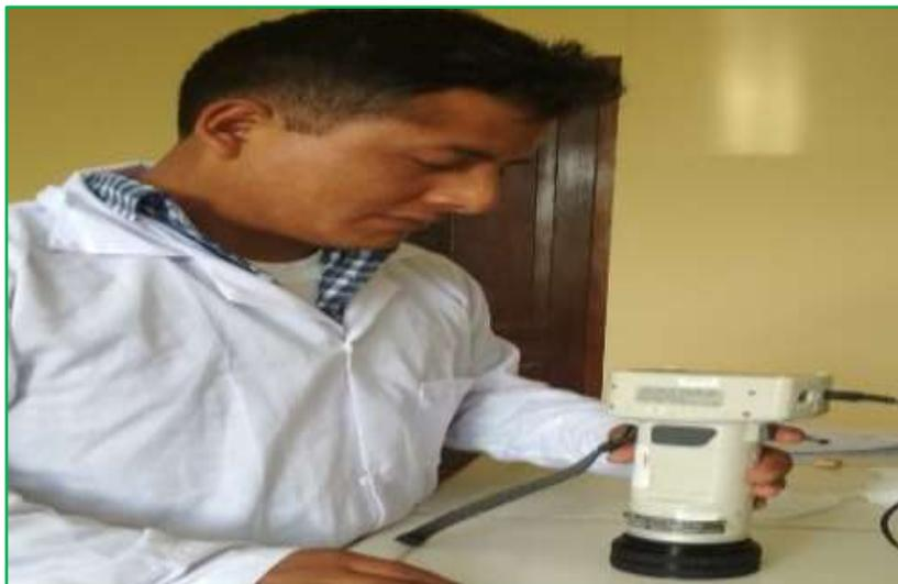
IMAGEN 7: Colorímetro KONICA MINOLTA módelo CR-400.
