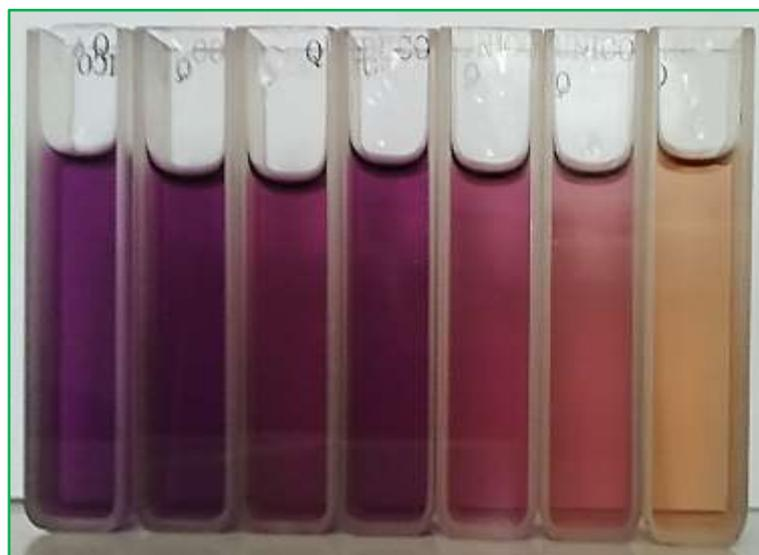
IMAGEN 12: Curva de calibración para capacidad antioxidante
