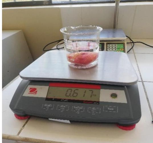
**Imagen 2B.** Determinación de gravedad específica
