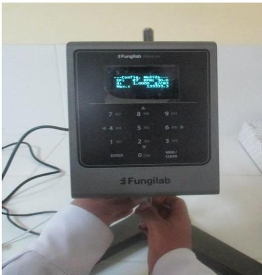
Calibración de viscosímetro FUNGILAB
