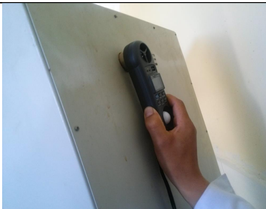
FOTO N° 4. Midiendo la velocidad de aire y humedad relativa.
