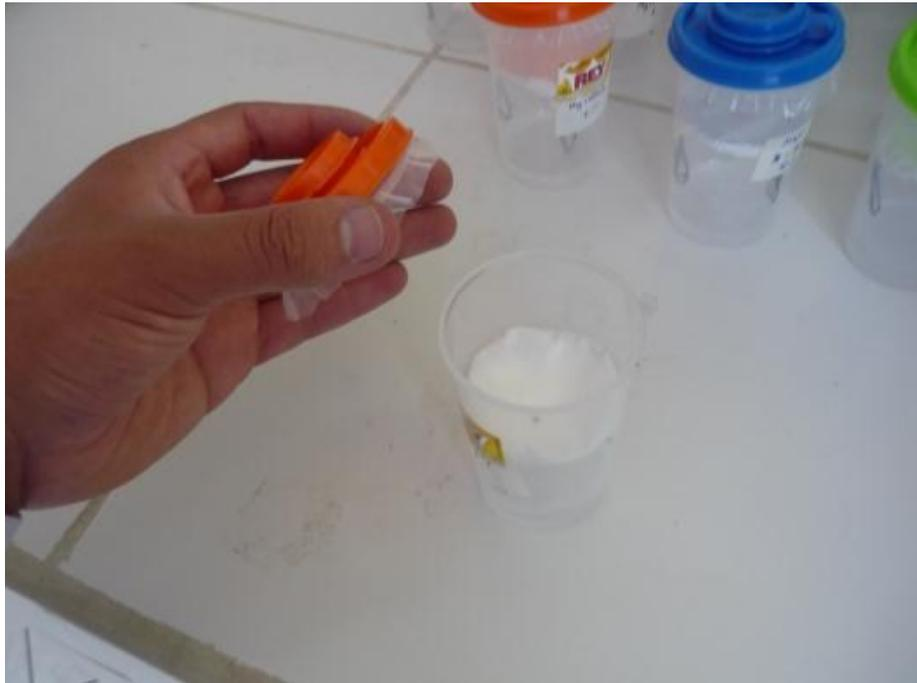
Imagen 3: Cama de papel de nitrocelulosa colocado en el pote con cierre hermético
