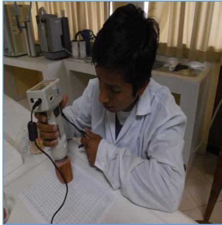
Figura 31: Determinación del color en la miga del pan tipo molde.
