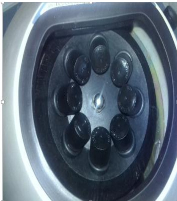
Imagen 8: Centrifugación de la solución del almidón a una velocidad de 3000 rpm
