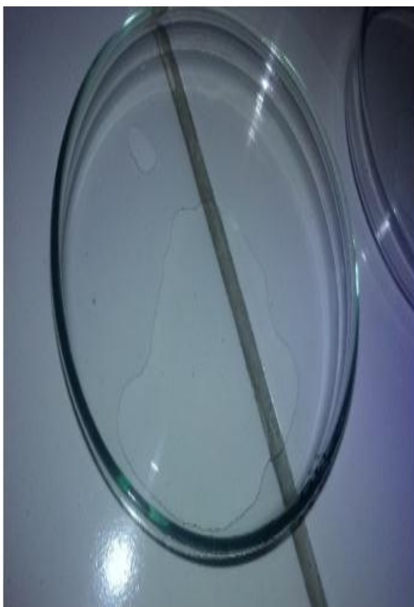
Imagen 5: Solución del almidón de 2.5 ml en placas Petri para el secado respectivo en la estufa.
