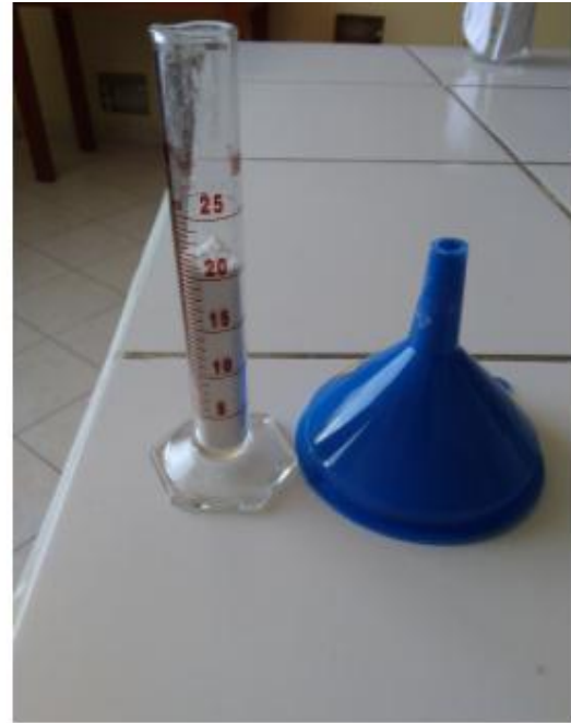
Imagen 10: visualización del volumen que ocupa el almidón nativo para el cálculo de la densidad
