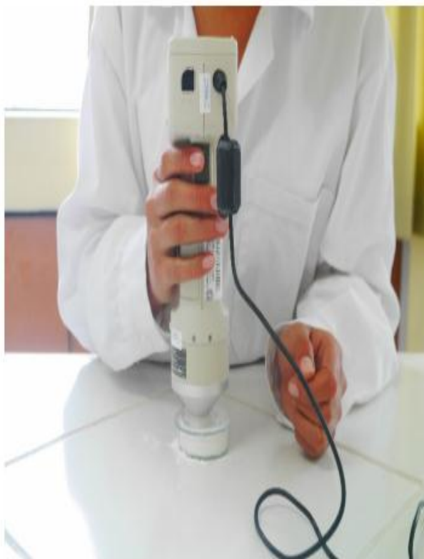
Imagen11: tomando la lectura del almidón en el colorímetro
