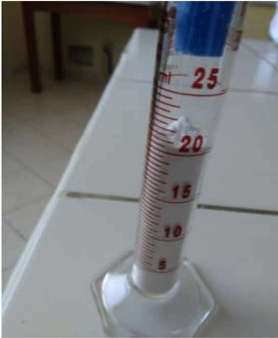
Imagen 9: Acondicionamiento del almidón en la probeta para determinar la densidad aparente
