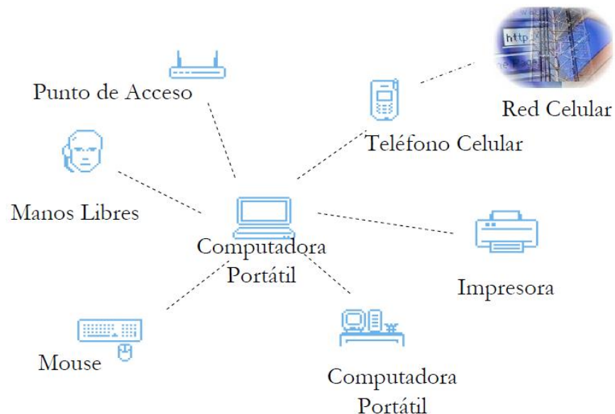
Figura 7: Modelo de conectividad de Bluetooth. Fuente: (Sparacino Lorefice, 2003).
