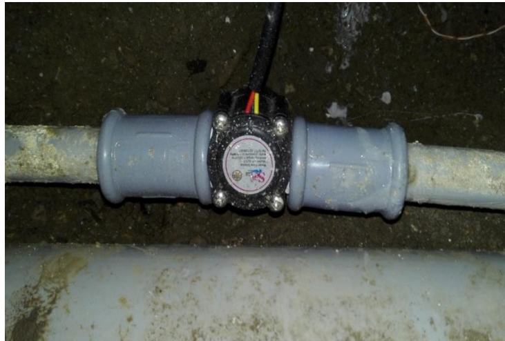
Figura 32: Verificación y validación sensor de flujo.
