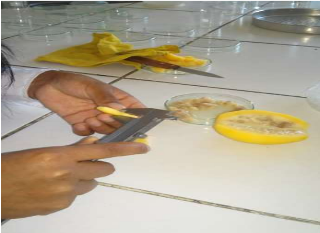
Fotografía 05: Medida del espesor la papayita nativa con ayuda de un vernier.
