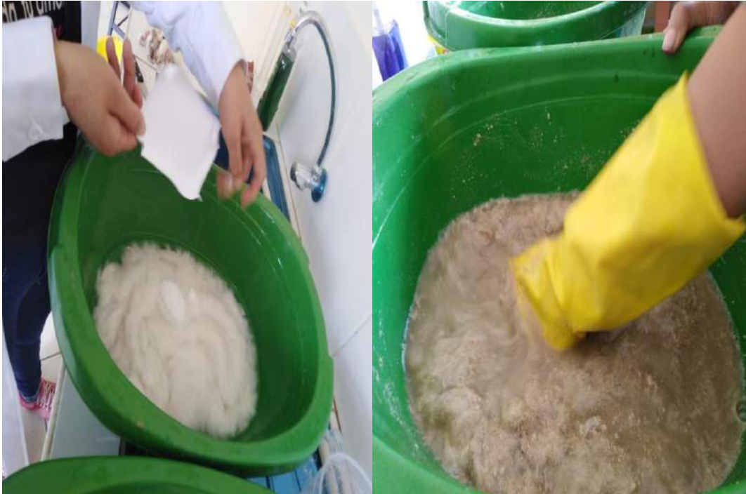
Imagen 03: Adición de tara en polvo y cloruro de sodio
