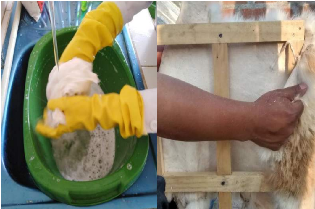
Imagen 05: Lavado y posterior ablandamiento de las pieles curtidas
