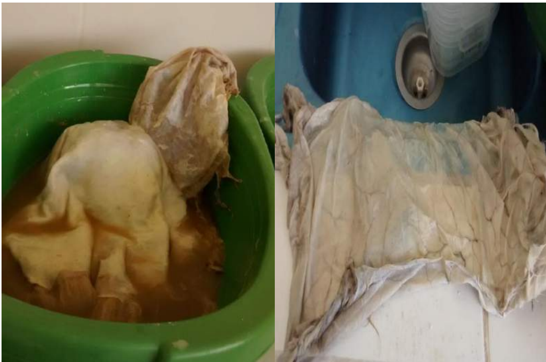
Imagen 02: Operación de descarnado de la piel de conejo
