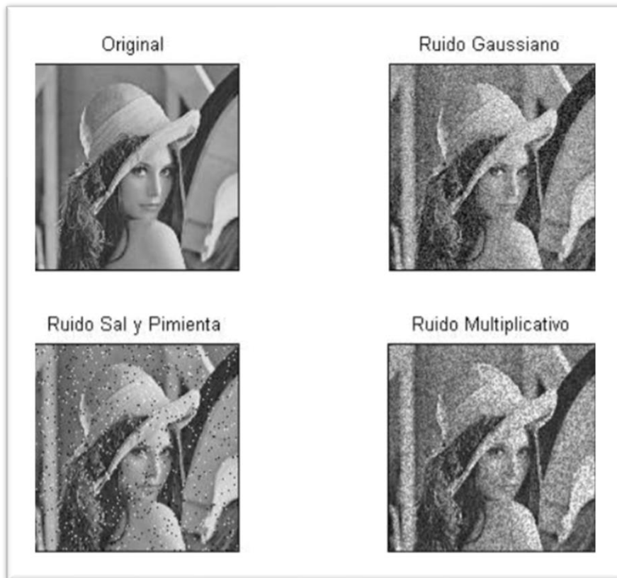
Figura: 7 Diferentes tipos de ruido afectando a una imagen.
