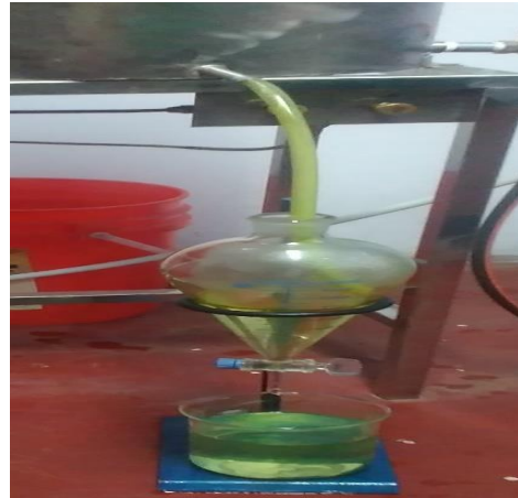
Imagen 4: Condensación de hidrolatos y aceites esenciales
