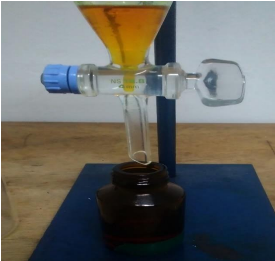
Imagen 7: Separación del aceite esencial del hidrolato por diferencia de densidades
