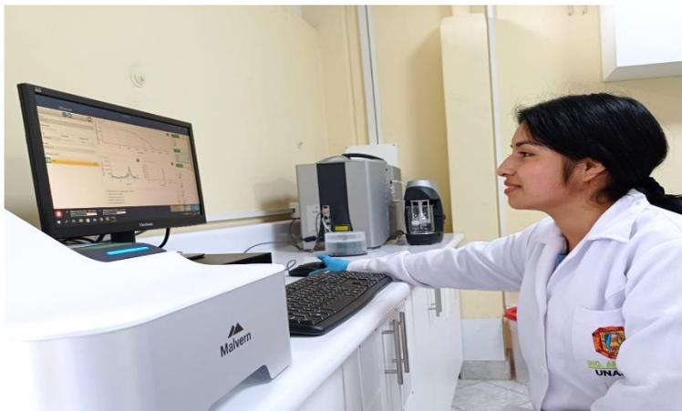
**Imagen 5.** Preparación de muestras para determinar tamaño de partícula y potencial  $\zeta$
