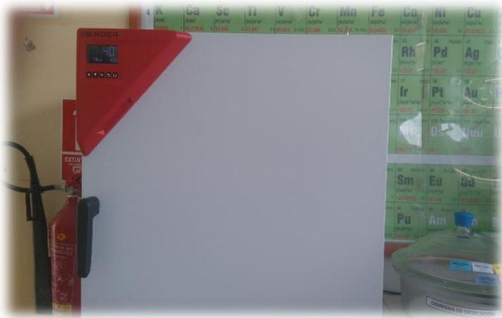
Fotografía 5. Acondicionado en estufa a 40, 50 , 60 °C y velocidad de (0.5 y 1 m/s) para someter al secado
