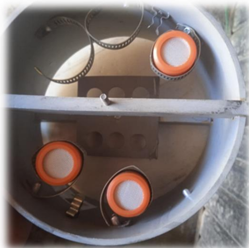
Filtro pasivo Combi para \text{SO}_2 y \text{NO}_2 instalados en la porta filtros
