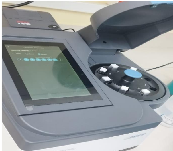
Anexo 23. Lectura de absorbancia a 515 nm en espectrofotómetro
