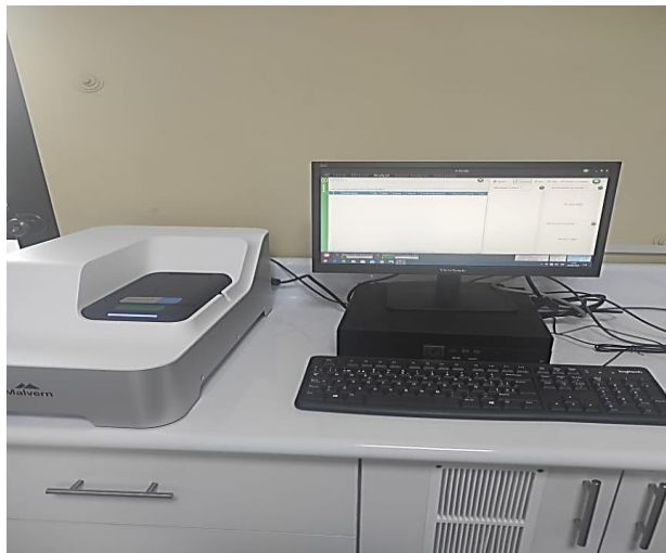
Anexo 26. Fotografía de la medición del tamaño de partícula en el Zetasizer ZSU 310.
