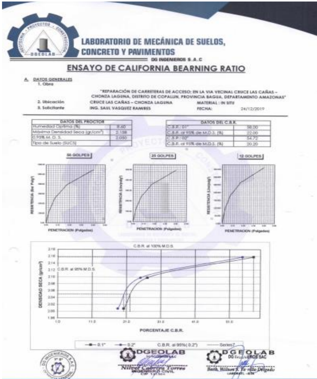
Figura 07. Muestra de un expediente técnico de los datos del OMC, MDD Y CBR
