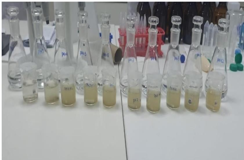
*Nota:* Preparación de soluciones del NC/NA a diferentes concentraciones y pH.
