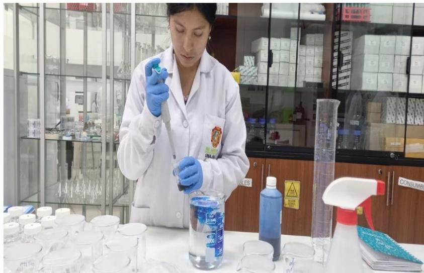
*Nota:* preparando la solución acuosa de AM a pH (5,6 y 8) para aplicar el NC/NA a (20, 30 y 50) ppm de concentración.
