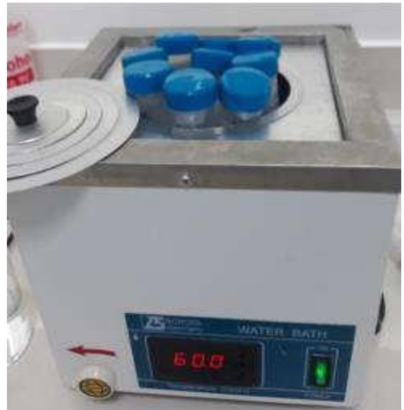
Imagen 12. Calentamiento de muestra a (60,70,80 y 90) por 30 min
