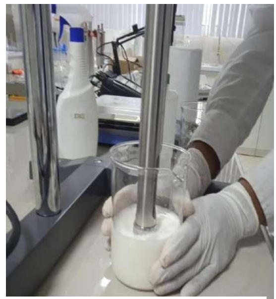
Imagen 19. Se realizó el proceso en ultraturrax a 10000 rpm hasta formar la espuma
